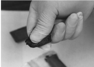
Zum Schutz gegen Hautreizungen dünne Kunststoffhandschuhe tragen. Die benötigte Menge vom Stift abbrechen und in der Hand kneten, bis das Stück eine gleichmäßige Farbe hat.
